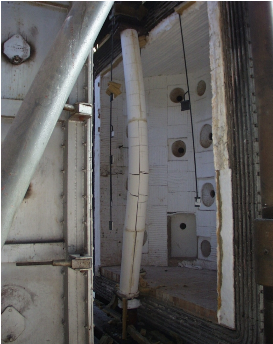
Zkouška sloupu dle EN 1365-4
